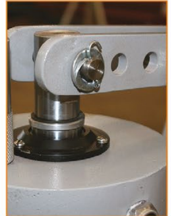
Sistema de vedação do acionador para freios de translação e elevação Sistema de vedación del accionador para frenos de translación y elevación
